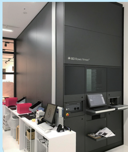
BD ROWA社のVmax(左側に2つの医薬品の払い出し口、ちなみに高さは3.5mあり世界一の高さである)
